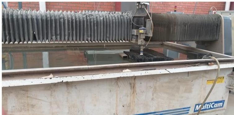
**Fig. 4 -** Máquina de corte por chorro de agua.
