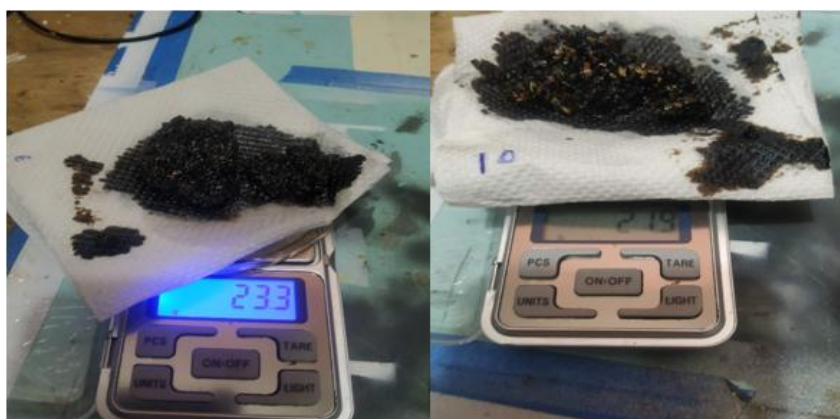
Fig. 4. Determinación de la capacidad de absorción del olole en un derrame de petróleo
