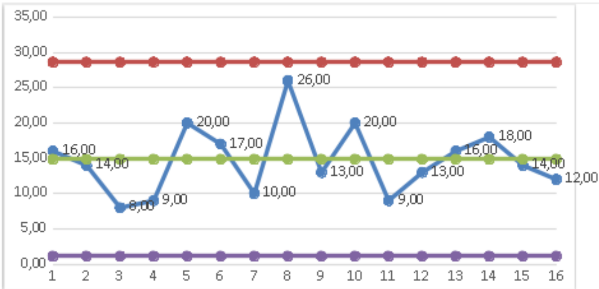
Fig. 16. Gráfica de control para variables ( \bar{X} ) de las causas para el factor servicio
